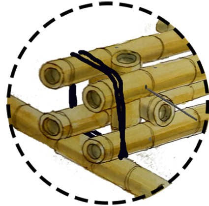
Fig. 2.9. Unión de las piezas de la columna
