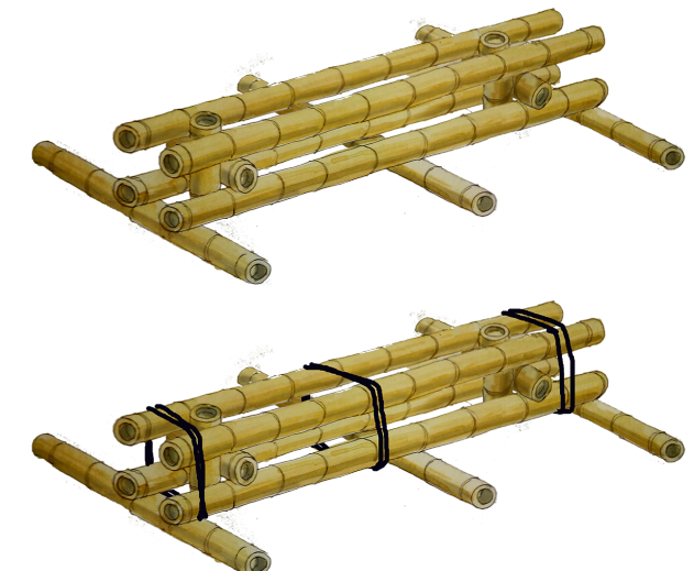
Fig. 2.8. Configuración y amarre de columna
